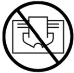
**MISE EN GARDE :** pour éviter une surchauffe, ne pas couvrir l'appareil de chauffage
