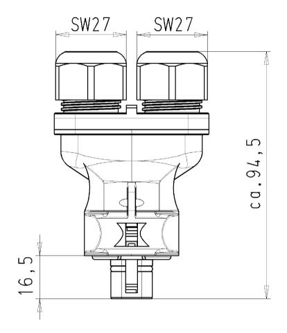
STECKERTEIL MIT DOPPELZUGENTLASTUNG 96.032.4253.0 10W 08.10.2008 M1:1
