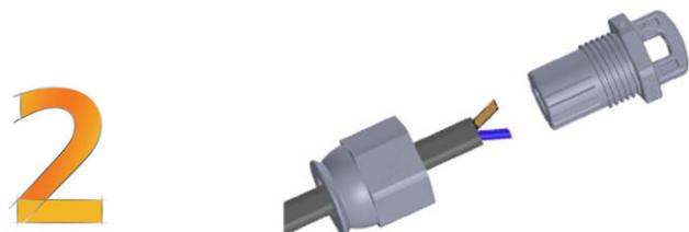
Insérez un tournevis dans l'anse du bouchon de terminaison pour le bloquer et serrez l'écrou à 7 Nm.
