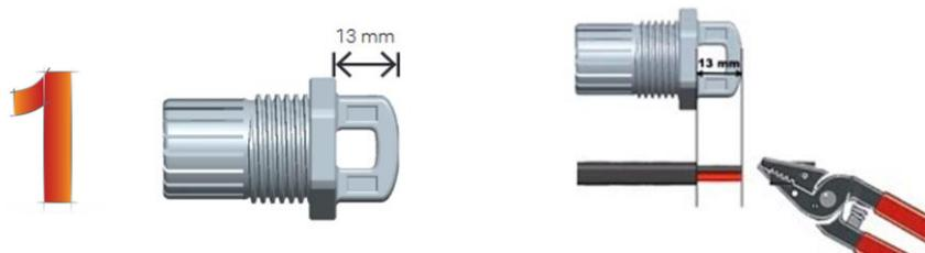
Insérez le câble dans le corps du bouchon de terminaison afin que chacun des deux fils conducteurs arrive chacun sur un côté opposé du séparateur interne.
