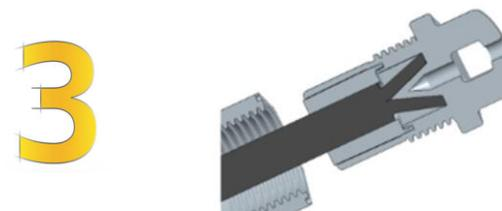
Faites glisser le câble à travers l'écrou hexagonal. Il y a un manchon à l'intérieur du corps du bouchon qui doit rester en place.
