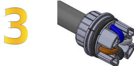
Recourbez les fils dans les creux du corps du bouchon de terminaison et coupez-les à la longueur nécessaire.
