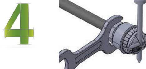
Placez le capuchon sur le corps du bouchon. Insérez un tournevis dans l'anse du bouchon pour le bloquer. Faites tourner l'écrou hexagonal à la main ou à l'aide d'une clé jusqu'à que le mécanisme de verrouillage soit vissé
