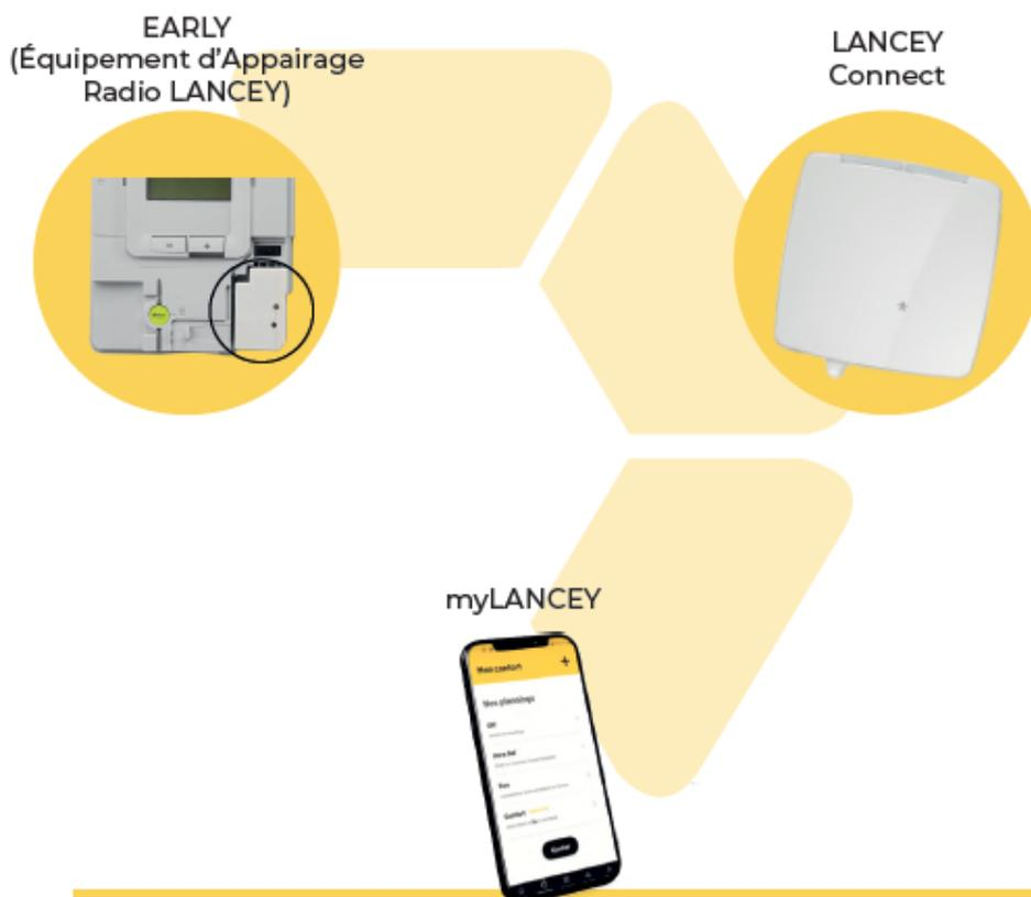
Grâce aux informations de production photovoltaïque enregistrées par le Linky et transmises par l'EARLY au LANCEY Connect (WiFi), ce dernier déclenche au bon moment la production d'eau chaude sanitaire. L'application myLANCEY permet de suivre en temps réel votre consommation.
